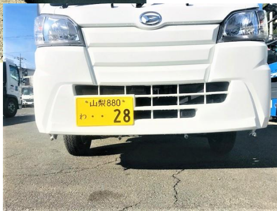
前方加圧散水
