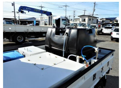
手元散水・側方散水
